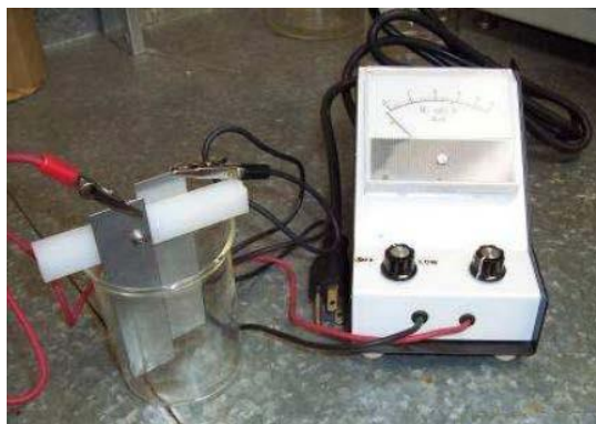
Figura 767 - 1. Equipo para determinar la carga de partículas
